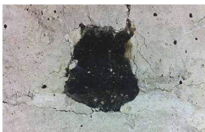
Imagem em close de uma seção transversal de concreto mostrando as propriedades de dilatação da fita hidroexpansiva PENEBA SW.
